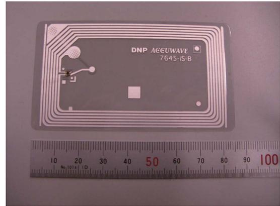
Fig. 3. Passive IC tag.
